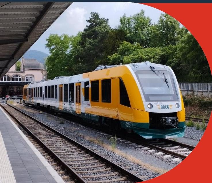
Der Alstom Coradia™ Lint™ 54 ist ein moderner, leistungsstarker und erprobter Niederflur-Dieseltriebzug für den Regionalverkehr auf nicht elektrifizierten Strecken.
